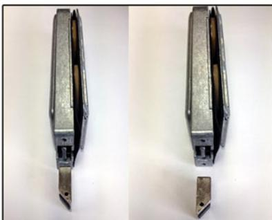
Falle aus dem Schloss herausziehen und um 90° drehen. Danach setzen Sie die Falle wieder ein und ziehen die Kreuzschlitzschraube fest an.
