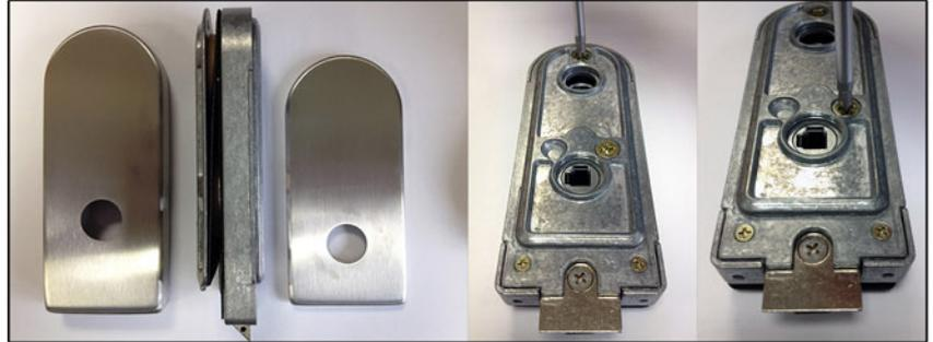
Demontage des Schlosses durch entfernen von 2 Kreuzschlitz-Schrauben
