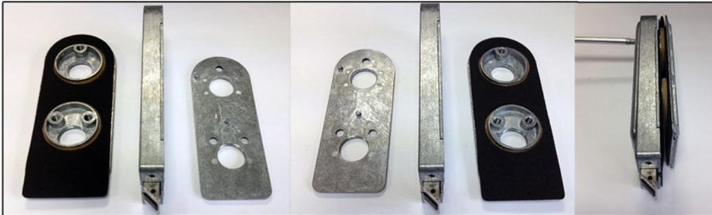
Tauschen Sie die losen Platten. Anschliessend kann das Schloss wieder zusammenschraubt werden.
